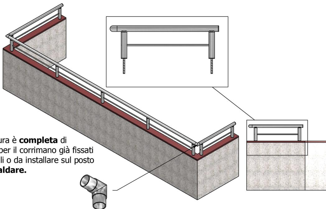
La fornitura è **completa** di raccordi per il corrimano già fissati ai pannelli o da installare sul posto **senza saldare**.
